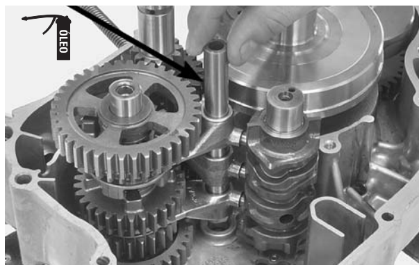
PINOS GUIAS EIXO DOS GARFOS SELETORES
